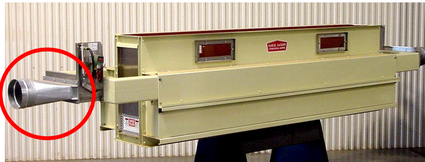
Entrée trémie – Percer un trou pour mesurer la pression statique.
