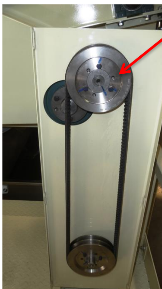
12 N.m (108 in-lbf) pour la bague sur les poulies réducteur de vitesse et moteur.
