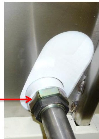
373 N.m (3 300 in-lbf) pour la bague "sans clé"
