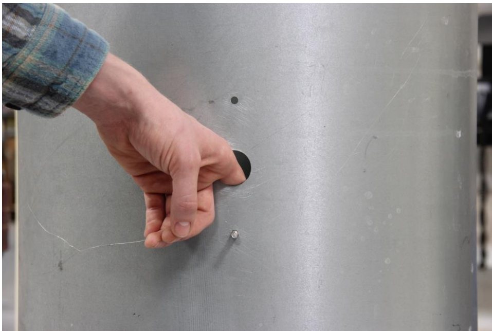
Figure 8: Fixer les vis en utilisant un écrou bloquant
