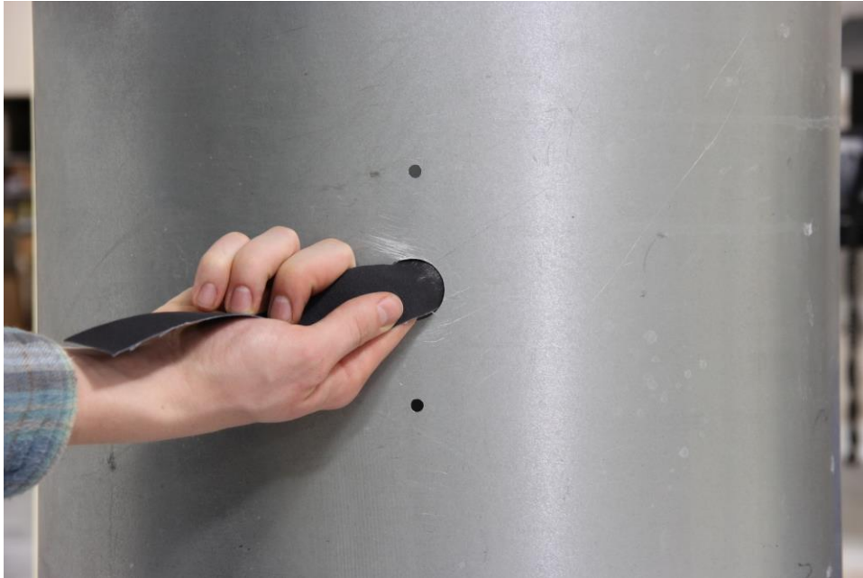
Figure 5: Poncer le pourtour des trous avec la toile émeri
