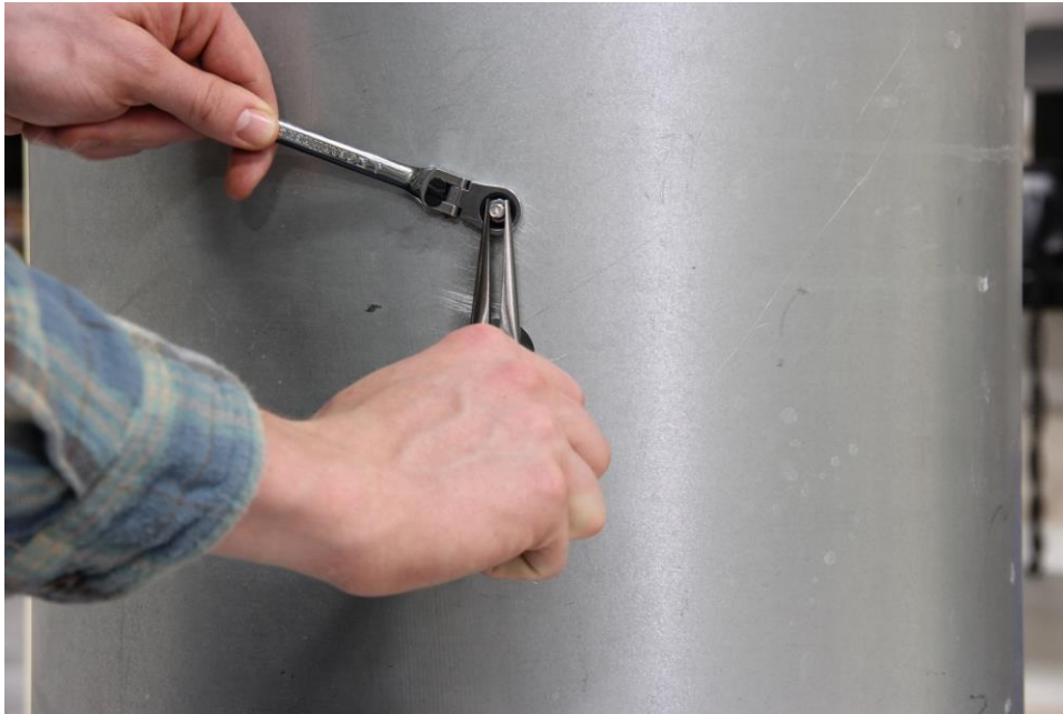
Figure 9: Serrer l'écrou bloquant tout en maintenant fermement la vis
