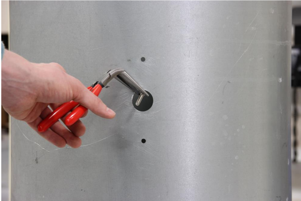
Figure 7: Insérer la vis en utilisant la pince à bec courbe
